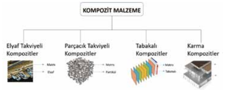
Şekil 2. Kompozit malzemenin takviye ediciye göre sınıflandırılması
